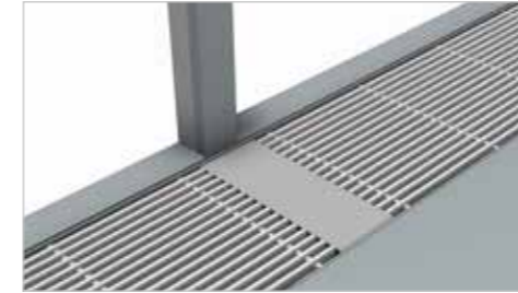
BODENKONVEKTOREN GESTOSSEN Bei grossen Längen können die Bodenkanäle mehrteilig gestossen und die Abdeckgitter unabhängig durchlaufend von der Bodenkanallänge eingeteilt werden (max. Gitterlänge 3100mm, einteilig). Allfällige Abschottungsbereiche (Raumteiler) werden zur Unterbrechung der Schallübertragung von Raum zu Raum eingesetzt. In diesem Bereich wird ein Abdeckblech aus Aluminium (z.B. naturfarbig eloxiert) eingelegt.
