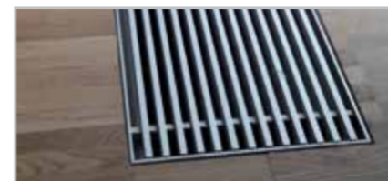
Un léger cintrage sur la largeur de la grille résulte du pressage à froid des pièces en aluminium.
